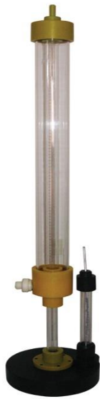
پرمامتر گلف یا نفوذسنج گلف (Guelph permeameter)
