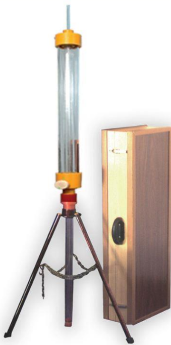
پرمامتر گلف یا نفوذسنج گلف (Guelph permeameter)
